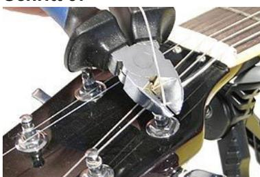
Zum Schluss den Saitenüberschuss mit einem Seitenschneider ab-zwicken und schon ist die erste Saite optimal gewechselt.
